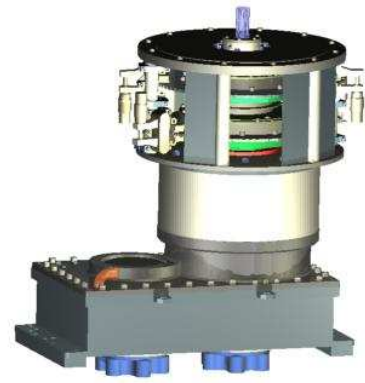
Planetenstirnradgetriebe mit Lastschaltreversierung für Schredder
